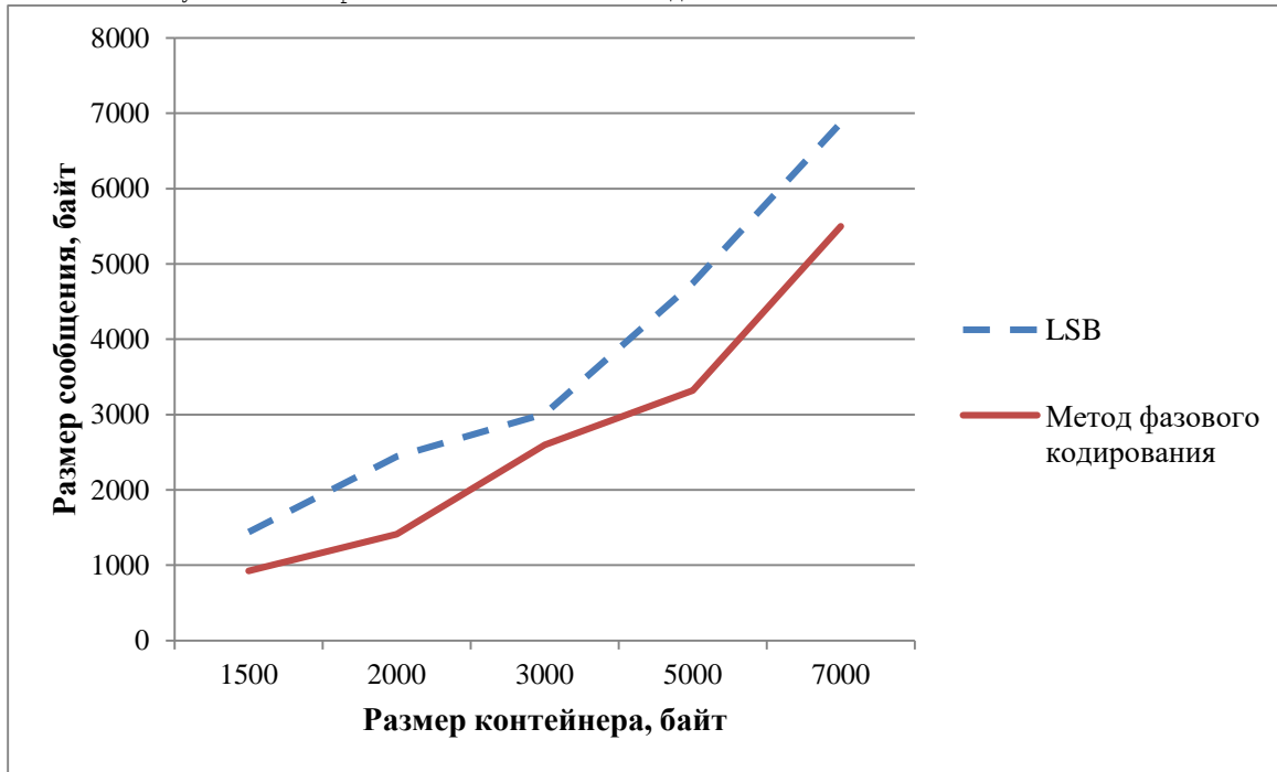
Рисунок 5 – График зависимости размера встраиваемого сообщения от размера контейнера
