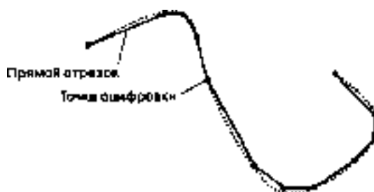
Рисунок 5.5. Оцифровка сложной линии. Пример аппроксимации прямыми отрезками при дискретизации кривой линии. Записываемые точки выбираются в зависимости от изменения направления линии. Каждая точка - дополнительная порция информации, содержащейся на карте.
