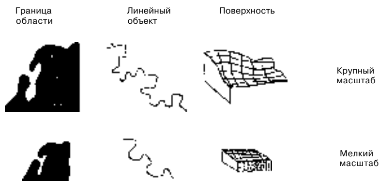
Рисунок 3.10. Изменение масштаба и сглаживание. Заметьте, как объекты упрощаются до сохранения только наиболее представительных характеристик.
