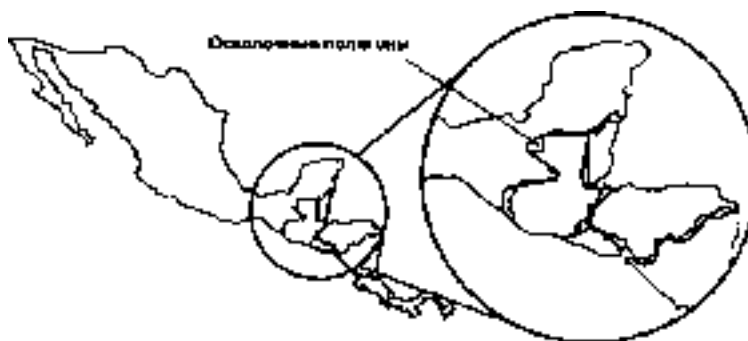
Рисунок 6.5. Осколочные полигоны. Они возникают из-за плохой оцифровки вдоль общих границ, где линия должна вводиться более одного раза. Сильно нерегулярные границы государств, как в Центральной Америке, особенно подвержены такой "кудрявости" (гаггтезз) оцифровки.
