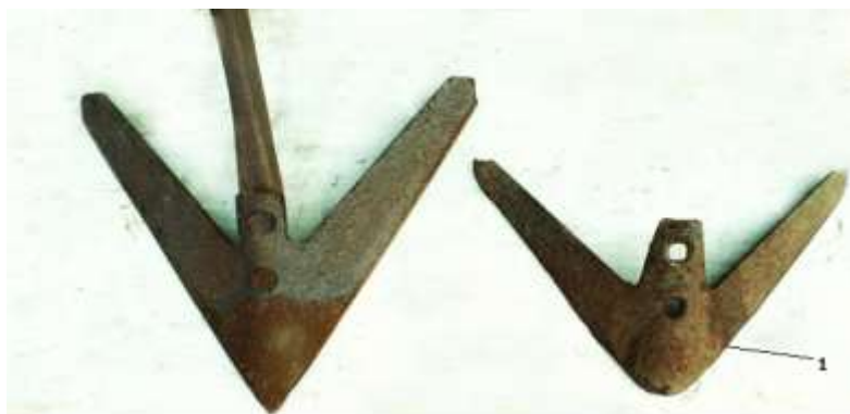
Рисунок 1 – Общий вид новой лапы культиватора (а) общий вид изношенной лапы культиватора (б); 1 – место износа, х4
