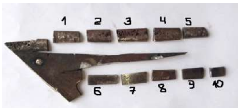
Рисунок 2–Общий вид образцов отрезанных из лапы культиватора
