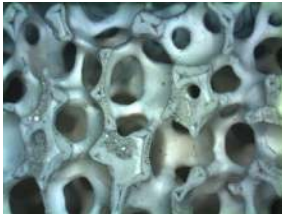
Рис. 1. Фрагмент пенокерамического фильтра в исходном состоянии (продольное сечение)
