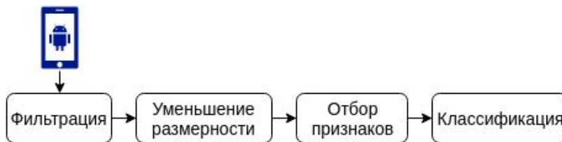
Рис. 2. Схема работы системы распознавания жестов
