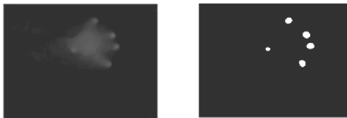
Рис. 3. Использование h(O(x), f) = \frac{\sum_{y \in O(x)} f(y)}{\|O(x)\|} в технологии мультисенсорного дисплея
