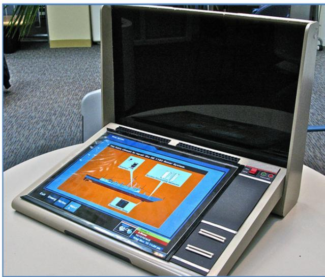
*Рис. 1.9. Система EDS – концепция электронного руководства по техническому обслуживанию (1980 г.). Программное обеспечение фактически работало на специальном растровом дисплее VAX 11/780 [11]*
