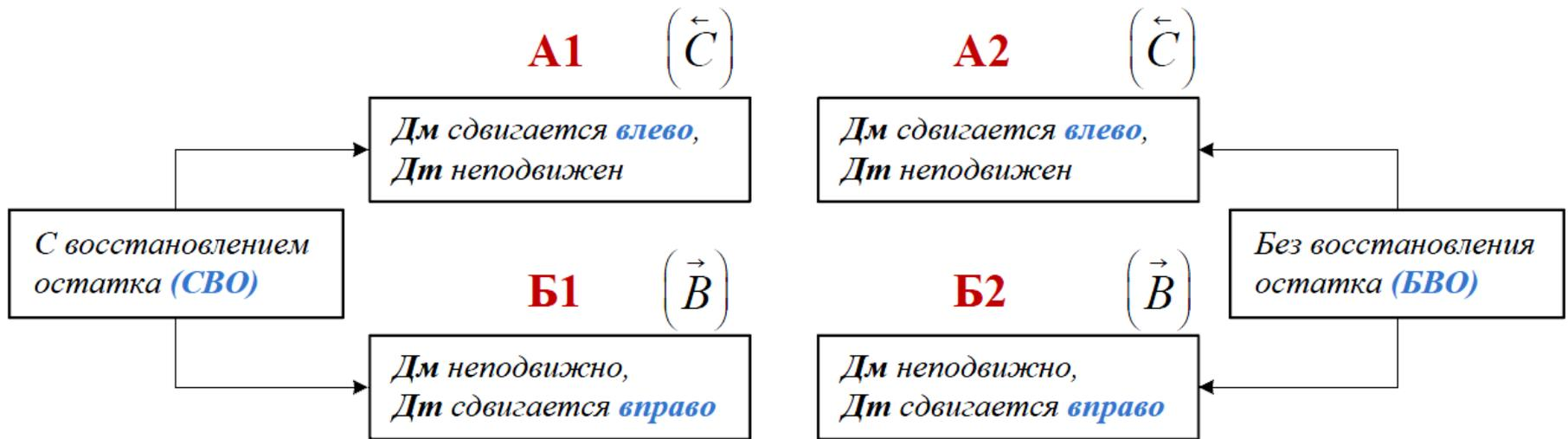
Рисунок 5.1 — Методы (алгоритмы) деления двоичных чисел (Дм — делимое  $A$ , Дт — делитель  $B$ ,  $C$  — остаток от деления)
