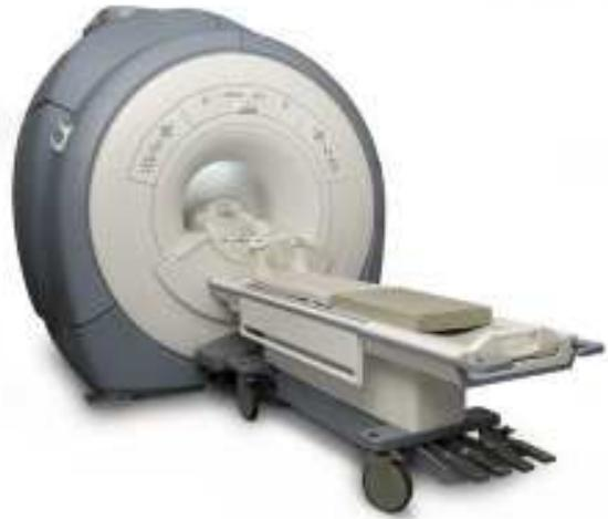
Первые томографы имели индукцию магнитного поля 0,005 Тл, однако качество изображений, полученных на них, было низким. Современные томографы имеют мощные источники сильного магнитного поля. В качестве таких источников применяются как электромагниты (до 9,4 Тл), так и постоянные магниты (до 0,7 Тл). При этом, так как поле должно быть весьма сильным, применяются сверхпроводящие электромагниты, работающие в жидком гелии, а постоянные магниты пригодны только очень мощные, неодимовые.
