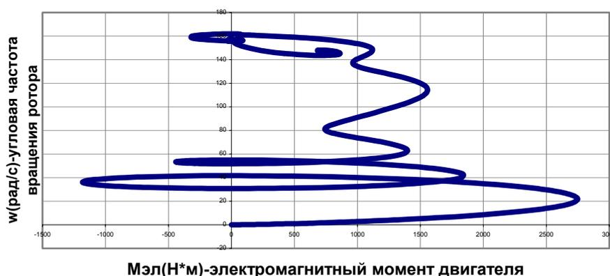
Рисунок 1 - Динамическая механическая характеристика
