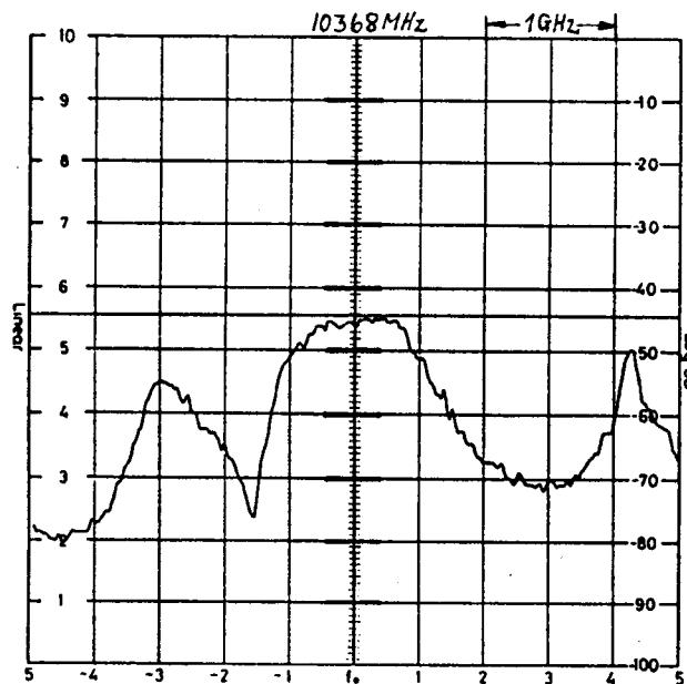
Die Bandbreite des Mikrostripfilters beträgt etwa 1 GHz bei einer Durchgangsdämpfung von ca. 1.5dB. Die Platine besteht aus RT DUROID RT5870, 0.79mm stark. Filterplatine und Verstärkerplatine können bei DL7QY bezogen werden zum Preis von jeweils 30.--DM. Der Transistor NE70083 zum Preis von 146.80 DM.
