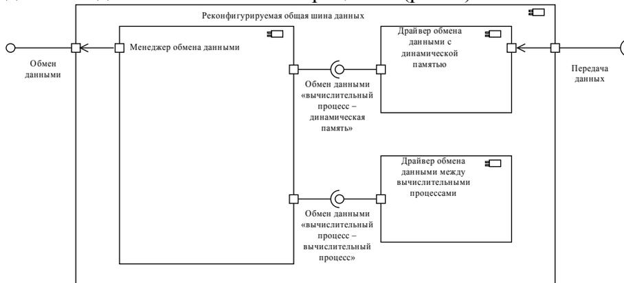
Рисунок 4. Структура реконфигурируемой общей шины данных
