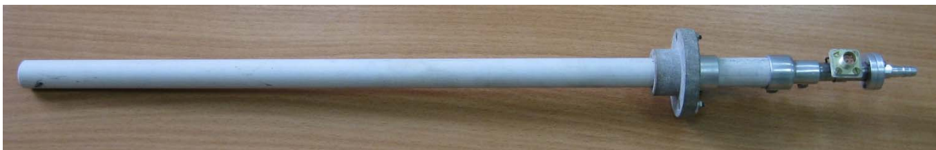
Рисунок 1 – Датчик активности кислорода на основе оксида гафния
