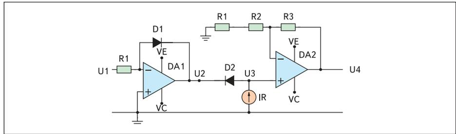
Рис. 3. Логарифмический усилитель с температурной компенсацией на диодах
