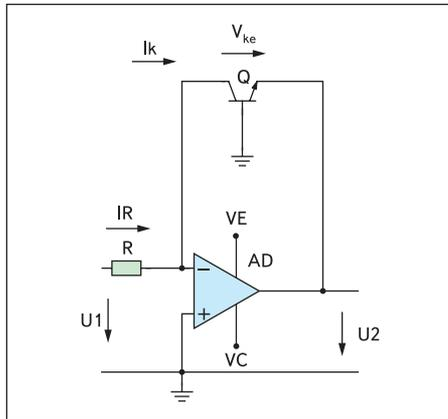
Рис. 2. Логарифмический усилитель с транзистором в цепи ООС
