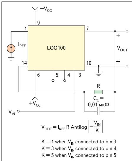
Рис. 12. Схема включения LOG100 для вычисления антилогарифма
