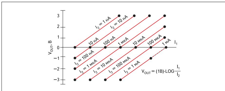
Рис. 19. Передаточная функция LOG102
