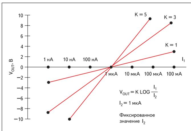
Рис. 8. Передаточная функция усилителя при изменении  $I_1$  и  $K$  и фиксированном значении  $I_2 = 1$  мкА
