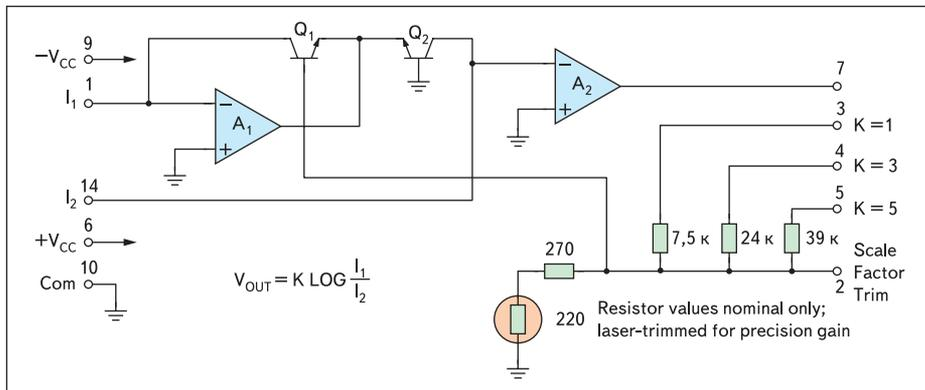
Рис. 7. Структурная схема LOG100
