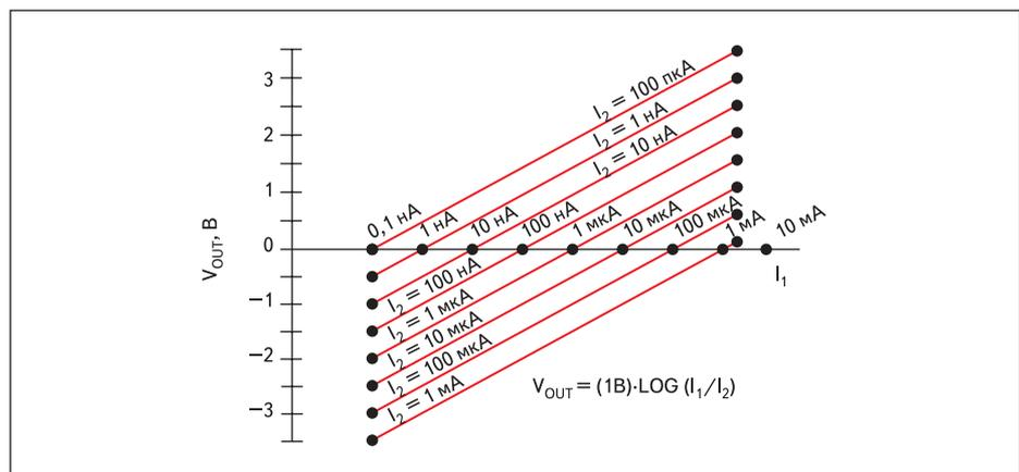
Рис. 16. Передаточная функция LOG101
