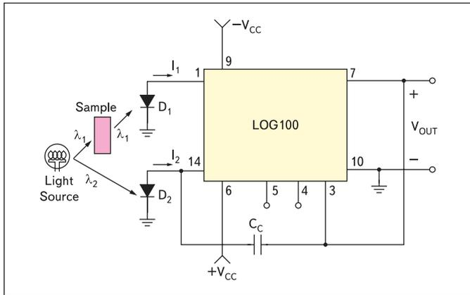
Рис. 11. Схема измерения логарифма коэффициента пропускания оптических объектов
