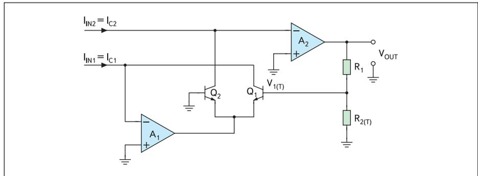
Рис. 4. Логарифмический усилитель с температурной компенсацией
