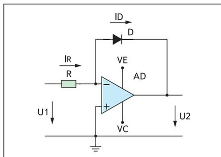
Рис. 1. Логарифмический усилитель с диодом в цепи ООС
