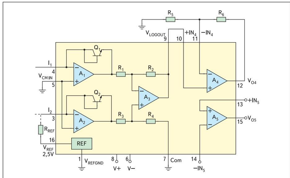
Рис. 25. Структурная схема LOG114
