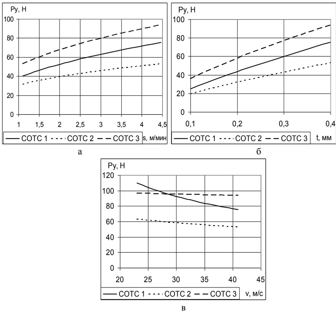
Рис. 2. Влияние составов применяемых СОТС на нормальную составляющую силы резания  $P_y$  при вариации режимов обработки: а –  $v = 41$  м/с,  $t = 0,4$  мм; б –  $v = 41$  м/с,  $s = 4,47$  м/мин; в –  $s = 4,47$  м/мин,  $t = 0,4$  мм
