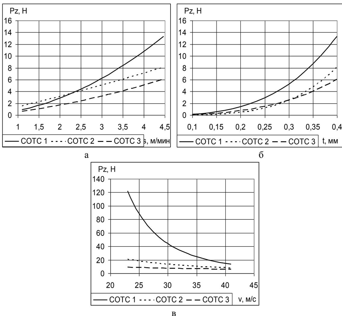
Рис. 3. Влияние составов применяемых СОТС на тангенциальную составляющую силы резания при вариации режимов обработки:
