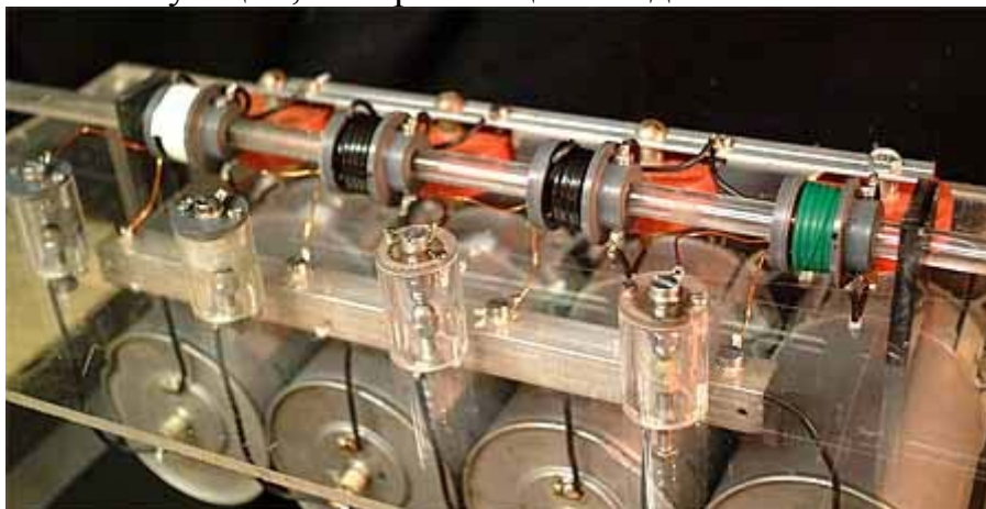
Рисунок 2.14 – Вид лабораторного макета секционного индукционного ускорителя (рельсотрон 2)
