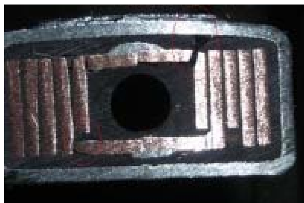
Рисунок 2.9 – Внешний вид (а) и сечение канала (б) многовиткового ускорителя (рельсотрон 2)
