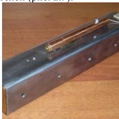
Рисунок 2.9 – Внешний вид (а) и сечение канала (б) многовиткового ускорителя (рельсотрон 2)
