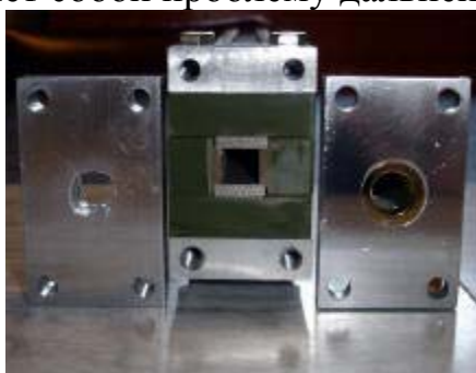
Рисунок 2.8 – Рельсотрон с прямоугольным сечением канала ускорения
