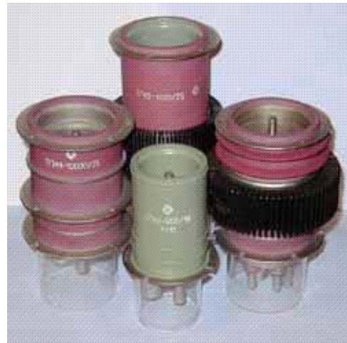
Рис. 3. 6. а) Схема импульсного тиратрона (слева): 1 – ввод анода, 2 – анод, 3 – диск сетки, 4 – экранирующий диск, 5 – верхний экран катода, 6 – эмитирующая поверхность катода, 7 – подогреватель, 8 – тепловой экран катода, 9 – экран; б) внешний вид тиратронов
