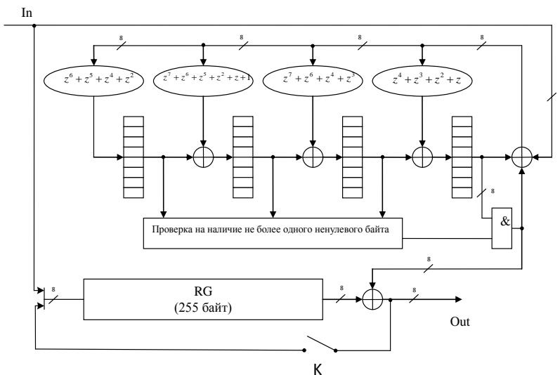
Рисунок 1 – Декодер (255, 251) кода Рида-Соломона, исправляющего двойные ошибочные байты
