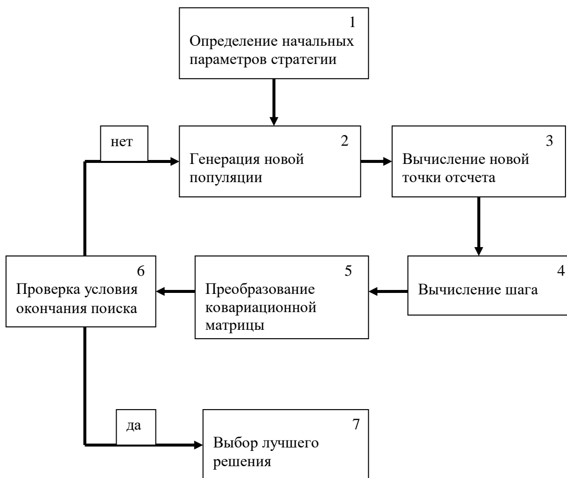
Рис. 1.5 Общий алгоритм эволюционной стратегии преобразования ковариационной матрицы
