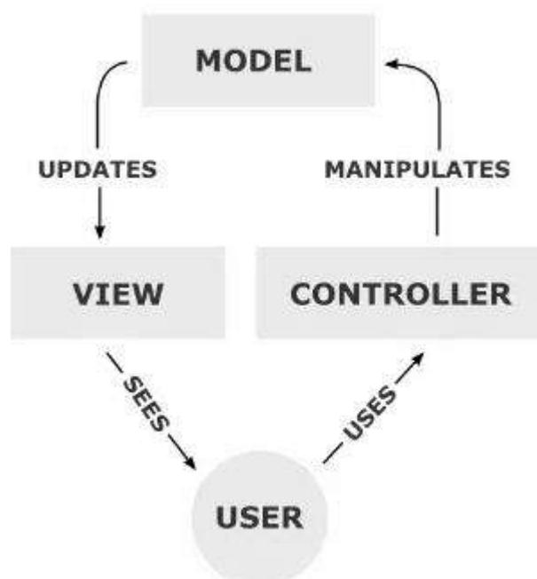
На рисунке показана структура одностороннего потока данных и пути его следования между различными компонентами, а также их взаимодействие.
