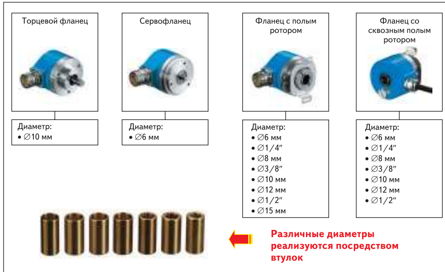
Рис. 4. Виды механических интерфейсов
