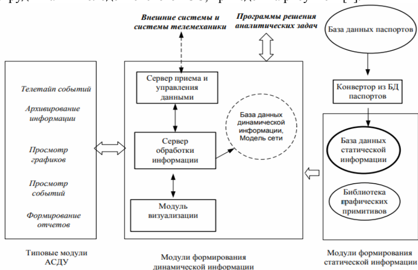
Рисунок 1 – Структурная схема автоматизированной системы диспетчерского управления с автоматическим формированием модели сети
