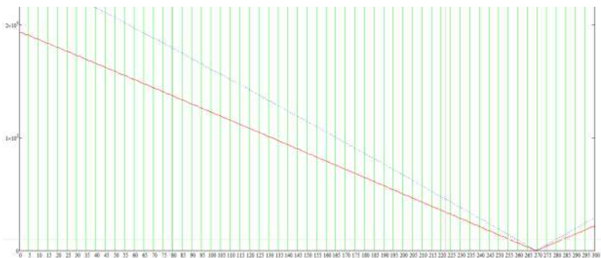
Рис. 3. Z_n = 0 , короткое замыкание на 270 км Fig. 3. Z_n = 0 , short circuit at the point of 270 km
