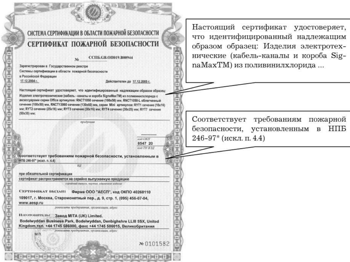
Рис.4. Образец сертификата пожарной безопасности на электромонтажную аппаратуру
