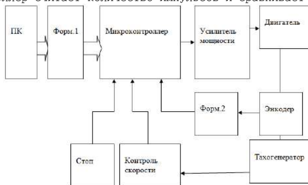
Рисунок 1 – Структурная схема системы управления серводвигателем
