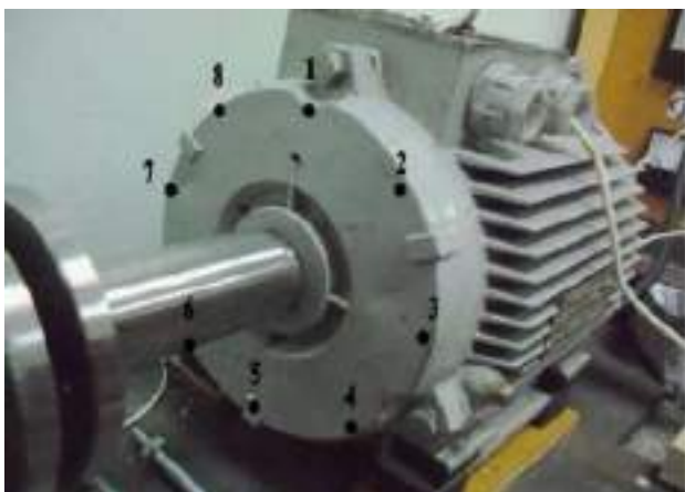
Рис. 6. Точки проведения замеров ВМП на двигателе АИР90L4УЗ
