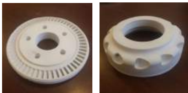
Рисунок 1. Проточная часть турбогенератора, изготовленная из полиамида марки ПА-12 по технологии SLS
