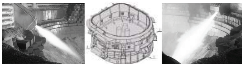
Рис. 1. Топливно-кислородные горелки в ДСП
