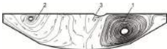
Рис. 2. Траектории течения расплава в вертикальном сечении ванны вдоль оси Y без учета термогравитационной конвекции
