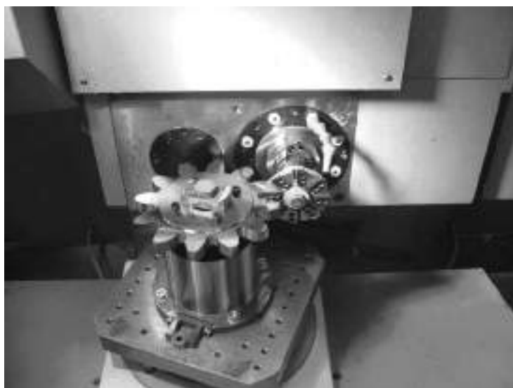
Рисунок 2. Взаимное расположение инструмента и заготовки в процессе эксперимента
