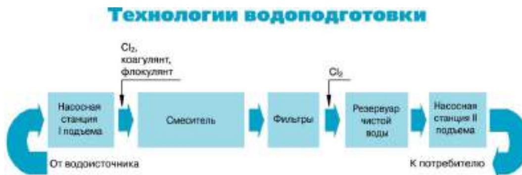
Рис. 1 – Технологическая схема системы водоподготовки
