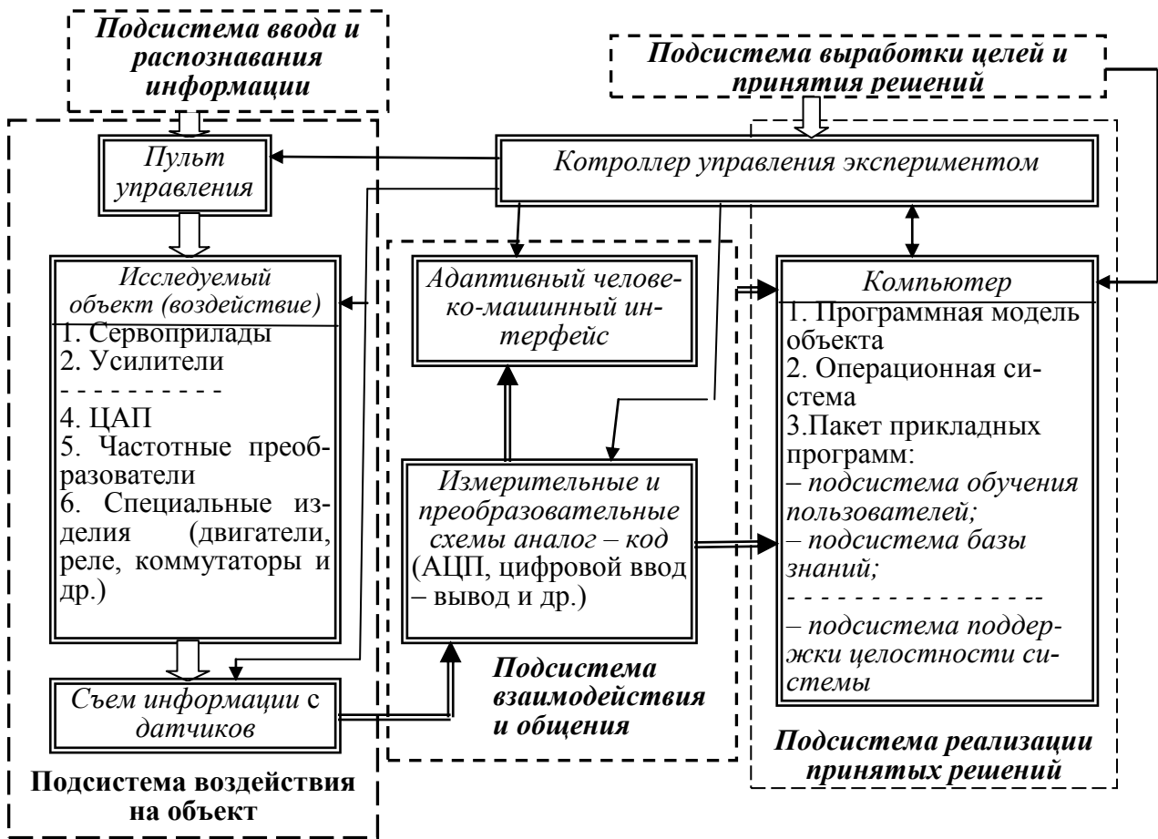
Рисунок 1 – Общий вид системы для полунатурного моделирования
