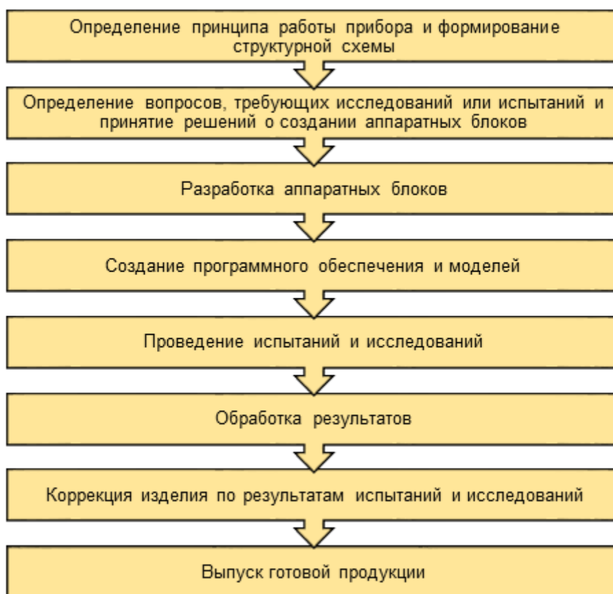
Рис. 1. Этапы разработки СМАД с применением методов полунатурного моделирования
