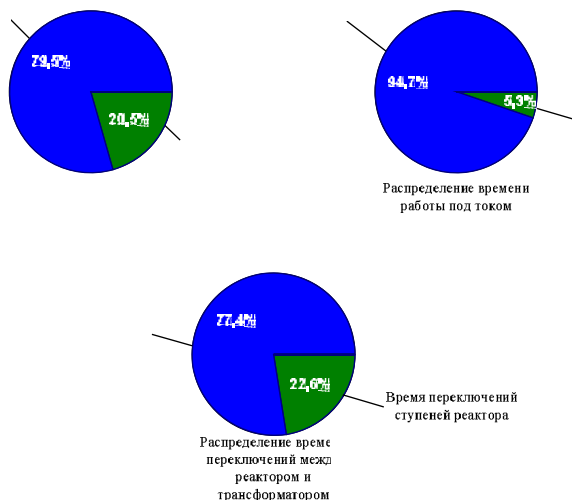
6. Круговые диаграммы распределения времени работы под током и времени приходящего на переключения устройств РПН реакто-
