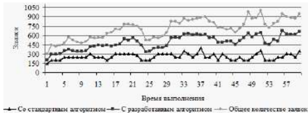
Рисунок 3. Производительность обслуживания заявок в хранилище данных с применением алгоритма приоритетной миграции данных
