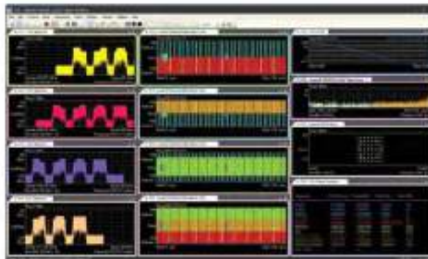
Рис. 2. Используя программу анализа объектов VSA, инженеры разработчики могут определить характеристики до пяти компонентов несущих одновременно
