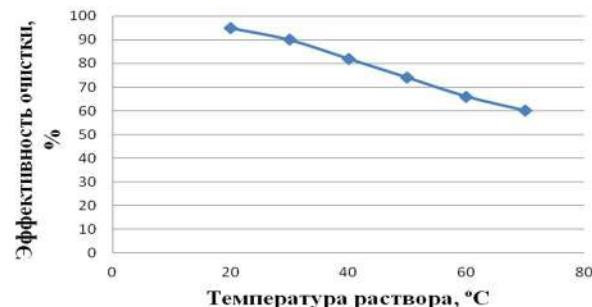
Рис. 1. Зависимость эффективности очистки от температуры поглотительного раствора
