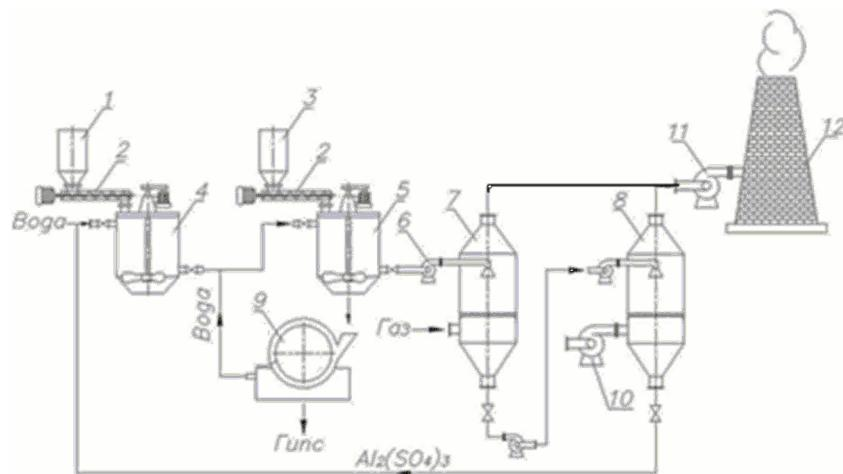
Рис. 3. Технологическая схема очистки газов от диоксида серы алюмо-сульфатным способом:
