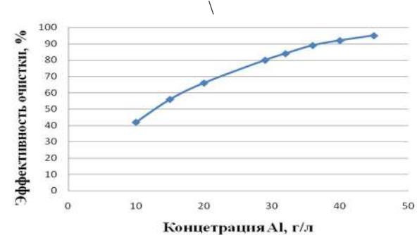
Рис. 2. Зависимость эффективности очистки от концентрации алюминия в растворе
