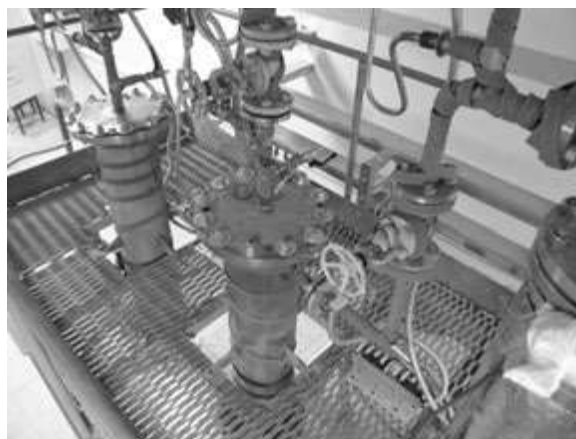
Рис. 7. Сепараторы Е-1 и Е-2
