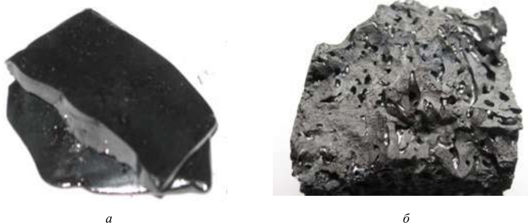
Рис. 1. Продукты, полученные на основе каменноугольного сырья: а – пек; б – кокс
