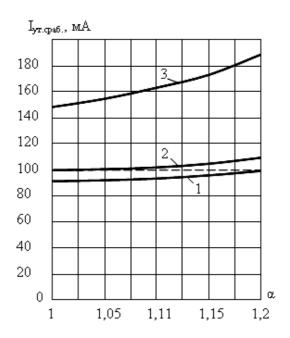
Зависимости  $I_{ym.cpaó}$ . УЗО от степени разбаланса lpha
