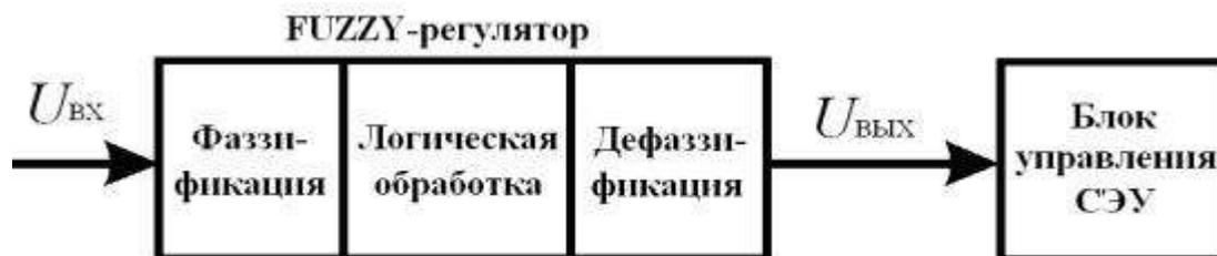
(рис. 1. Обработка сигнала fuzzy регулятора)
