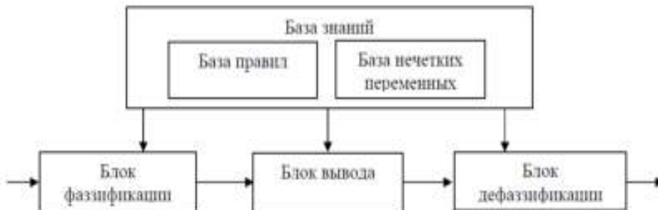
Рис. 9. Система нечёткого логического вывода
