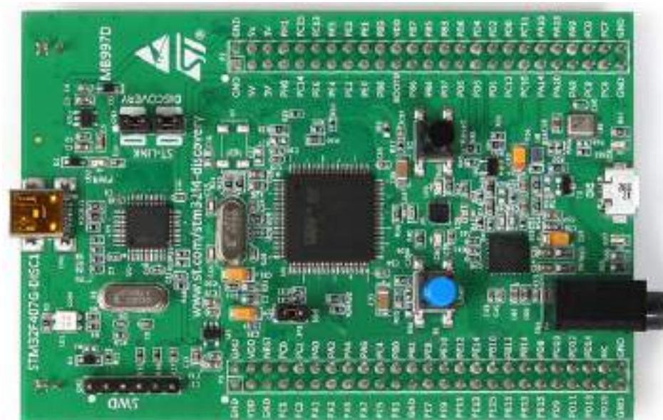
Рисунок 4 - Микроконтроллер STM32F407 – Discovery.
