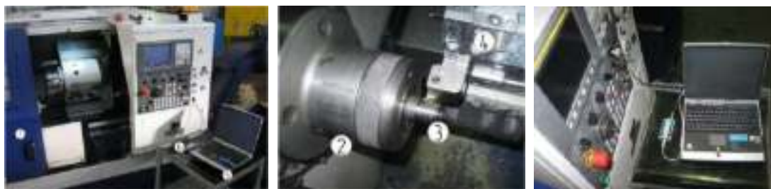
Рис. 2. Общий вид промышленной экспериментальной установки для многопроходного нарезания витков червяков резцом
