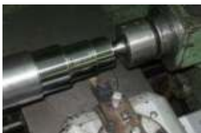
Рис. 1. Общий вид лабораторной экспериментальной установки для определения эталонной нагрузки: 1 – токарно-винторезный станок 16К20; 2 – патрон трехкулачковый с установленной в нем эталонной тарирующей заготовкой – 3; 4 – резец; 5 – динамометр УДМ-600, установленный на поперечном суппорте станка; 6 – измерительный усилитель МДУ-8; 7 – USB -осциллограф Disco , оснащенный аналогово-цифровым преобразователем (АЦП); 8 – ПЭВМ типа «ноутбук», оснащенная программой « USB -осциллограф»
