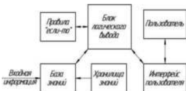
Рис. 6. Структурная схема экспертной системы с участием человека
