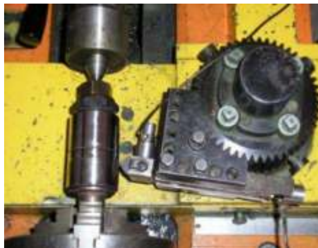
Рис. 7. Схема установки датчика вибраций
