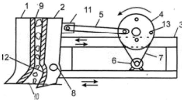
**Рис. 1. Щековая дробилка двойного дробления:** 1 – неподвижная щека; 2 – подвижная щека; 3 – рама; 4 – маховик; 5 – шатун; 6 – электродвигатель; 7 – клиновидный ремень; 8 – ось установки подвижной щеки; 9 – загрузочное отверстие; 10 – разгрузочное отверстие; 11 – проушина; 12 – углубление; 13 – отверстие в маховике
