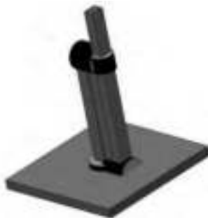
Рисунок 5 – Транспортировочное положение RRRRT манипулятора.
