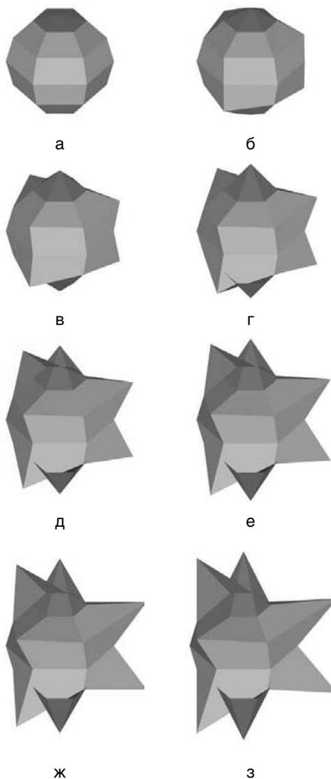
Рис. 7. Непластическая деформация пространственного объекта
