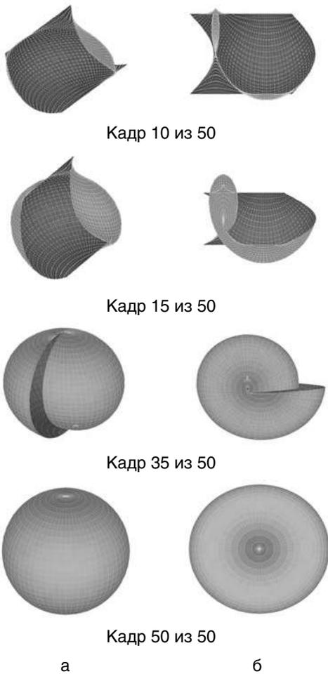
**Рис. 2.** Процесс формообразования сферы: в проекции произвольного наблюдателя (а); в проекции z-наблюдателя (б)
