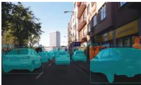
Рис. 1. Результат проведения семантической сегментации объектов
