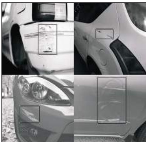
Рис. 2. Разметка объекта (в данном случае — внешние повреждения на поверхности транспортного средства) на изображении
