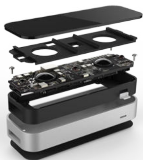
Рис. 1. Устройство датчика Leap Motion
