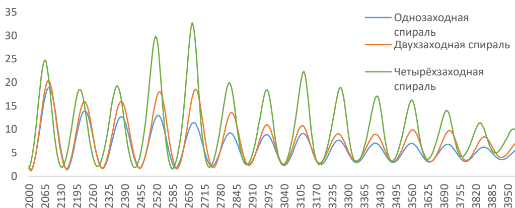
Рисунок 4. КСВ многозаходных антенн с одинаковым диаметром в диапазоне 2-4 ГГц.
